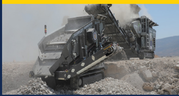
بدأت آلة التكسير والغربلة عملها في إعادة تدوير الركام الناتج عن الزلزال.
